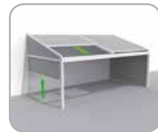
Lagune® + Sidefix = laterales móviles resistentes al viento
